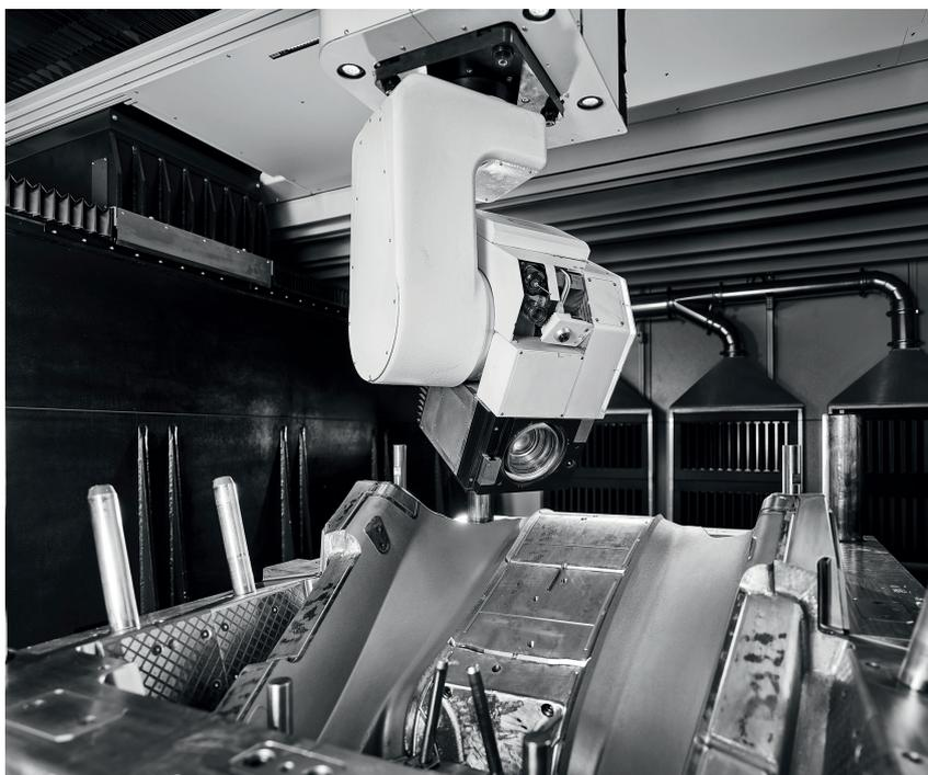
**Maschinen in Garagengröße:** Die AgieCharmilles Laser-4000-Anlagen bearbeiten Werkstücke bis 20 t. Reichle verfügt gleich über zwei dieser XXL-Anlagen. (© Reichle)
